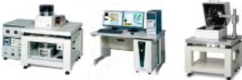
光てこ方式の AFM は、物理的相互作用として、探針・試料間に作用する原子間力を検出します。微小なプローブを持つカンチレバー（板バネ）カンチレバーのたわみ量を検出する光変位検出系、3 次元に微小移動を行うための圧電素子、の 3 つの要素から構成されています。カンチレバーのたわみ量を一定に保つように Z 軸の圧電素子を制御しながら平面方向に XY の圧電素子を走査することで、試料表面の微小な凹凸や物性等を測定する顕微鏡です。プレパレーション不要で、圧倒的な垂直分解能と TEM 並みの面分解能を有し、半導体から生体まで、あらゆる試料の 3 次元形状を簡便に観察できます。更に、試料の機械・電気・磁気・光学物性等の様々な物性を、その形状と同時に高感度測定できます。そして、SEM や TEM と違い、真空中での観察だけでなく、大気中、液中、ガス雰囲気中等、様々な環境下でのリアルタイム観察が可能です。
