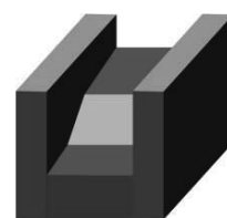
図 1.SSC 付反転リッジ型 光導波路の模式図
