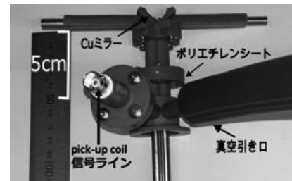
図 1 SLA 3D プリンターで造ったインサージョンのキャップ部
