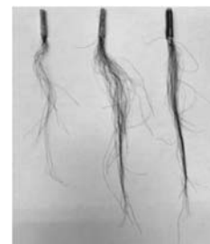
図 2. 処理を施した毛髪 (左) 未処理のアフリカ人毛 (中) 従来のパーマ処理をしたアフリカ人毛 (右) 1, 2 を含む水溶液で処理した毛髪
